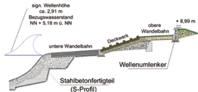
Ausbauquerschnitt Stat. 0 + 579 mit Bemessungswasserstand
